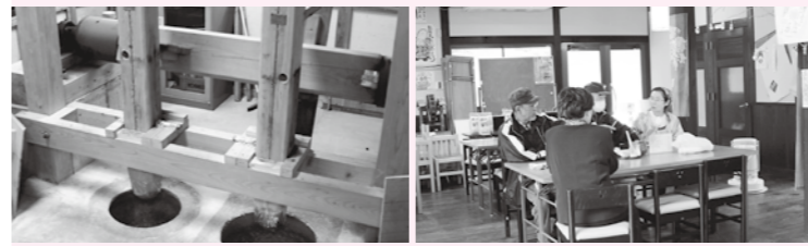
(右) レストハウスの店内。地域の人はもちろん、市外から訪れるお客さんも多い。都市部との交流を深める役割と、地域のきずなを深める役割を担っている。(左) 水車小屋の内部。根の谷川の水力を利用し、2つの臼で約8時間かけて精米する。
