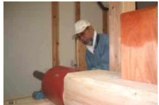
水車の車軸のボルトを点検する賀志古さん
