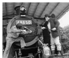
SL 48650号機の外観と 塗装を剥がす作業を 行っている様子
