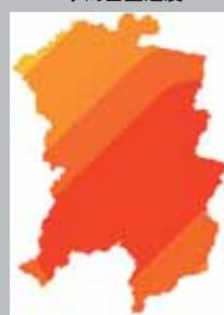
地形分類図から微地形区分を設定し、表層地盤の增幅度(地表面速度/工学的基盤速度)を推定
