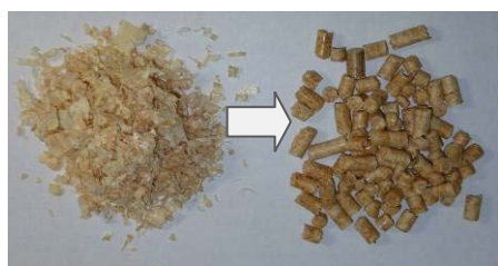
左: プレーナチップ(ペレット原料) 右: 木質ペレット (岡山県 M 社サンプル)
