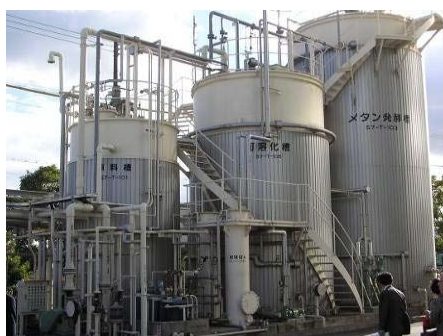
生活協同組合コープこうべ 六甲アイランド食品工場 湿式メタン醗酵槽
